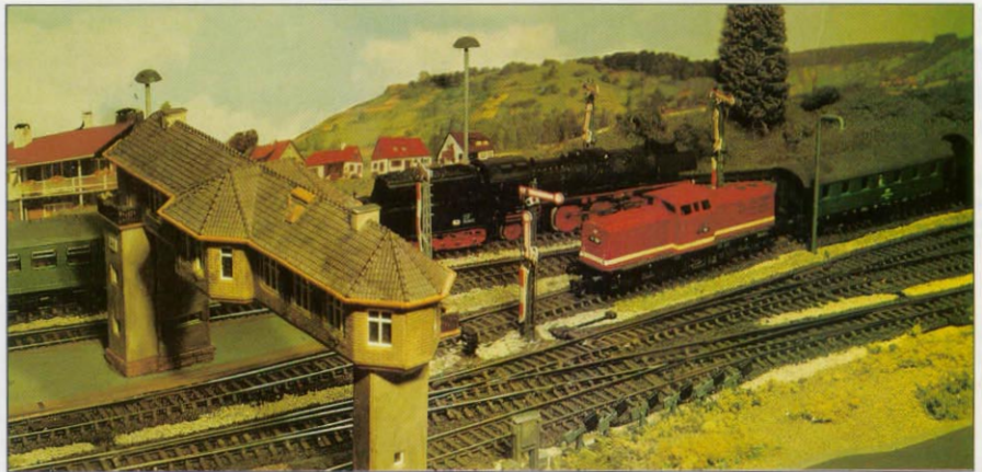
Bild 2 (oben). An der Ausfahrt des Pbf befindet sich ein Reiterstellwerk.
